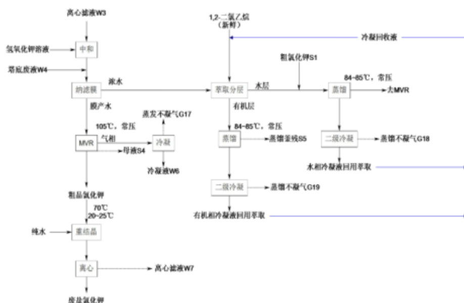
图 4.1-2 废盐处理工艺流程图
