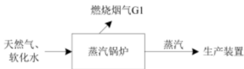
图 4.1-6 锅炉生产工艺及产污环节图
